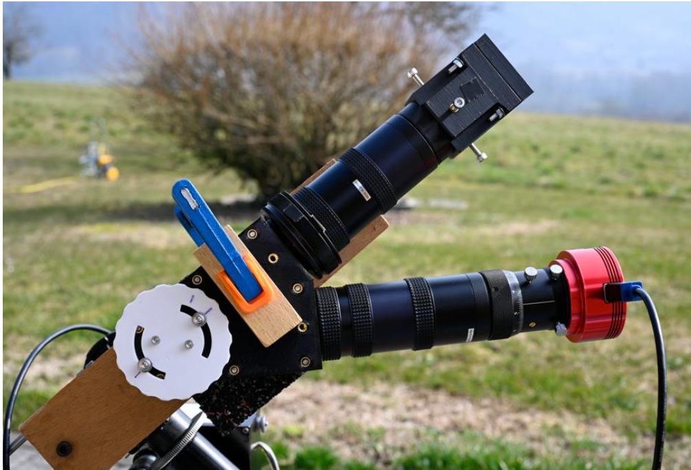
f_i = f_c = 200 \text{ mm} – map collimateur diffraction limited pour Ca K
