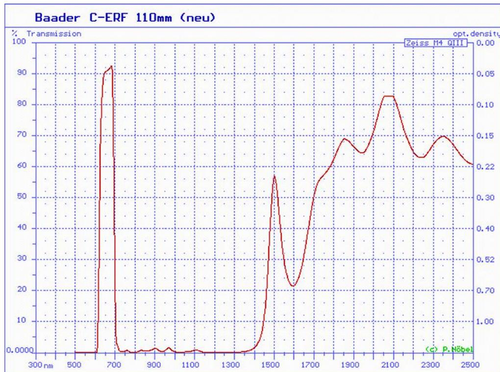
Fig 7 : Courbe de transmission du filtre ERF Baader – On constate le bon blocage de l'infrarouge proche. Le filtre ne redevient passant qu'au delà de 1.5 micron, dans l'IR thermique (Crédit : Peter Höbel)
