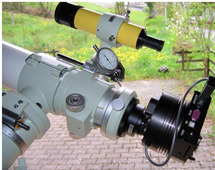
Fig 12 : Un comparateur à cadran au 1/100 de mm permet de faciliter la mise au point.
